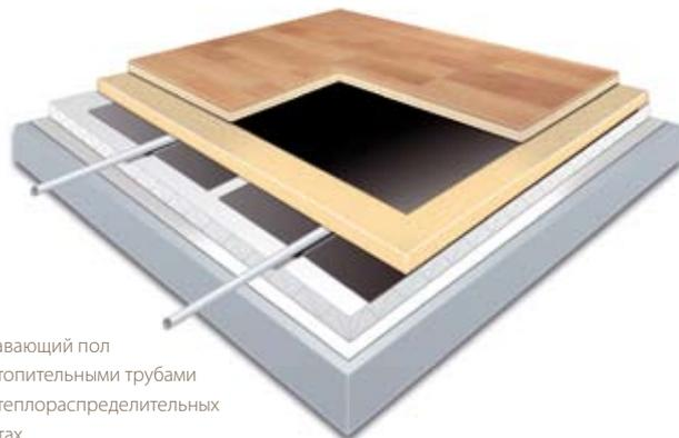
Плавающий пол с отопительными трубами на теплораспределительных щитах
