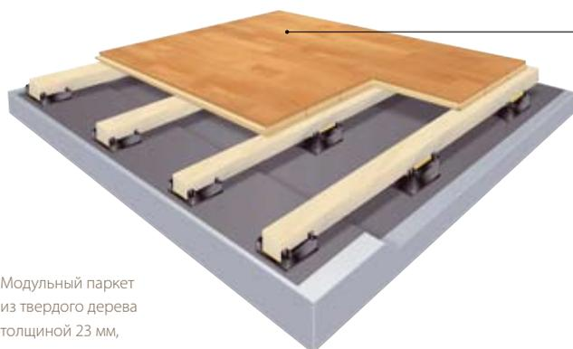
Модульный паркет из твердого дерева толщиной 23 мм, крепится гвоздями к лагам
