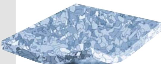
MIPOLAM TECHNIC EL5 представляет собой эластичное гомогенное виниловое токопроводящее напольное покрытие с электрическим сопротивлением  $5 \times 10^4 \leq rt \leq 10^6$  (EN 1081), выпускаемое в плитке.
