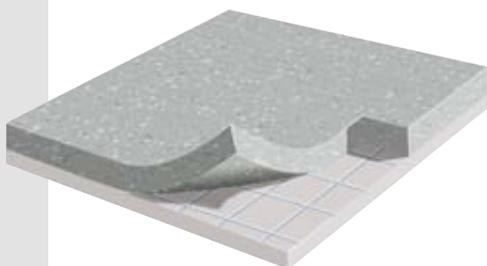
MURAL ULTRA представляет собой эластичное многослойное покрытие из пластифицированного ПВХ с вкрапленными цветными частицами в верхнем гомогенном слое. Производится в рулонах и имеет толщину 1.5 мм.
