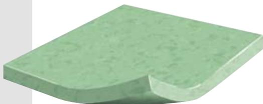
MIPOLAM SYMBIOZ™ представляет собой эластичное гомогенное прессованное напольное покрытие толщиной 2 мм, выпускаемое в рулонах. Относится к группе износостойкости T, что обеспечивает превосходную устойчивость к истиранию и износу в помещениях с высокой проходимостью. Вес составляет 2580 г/м<sup>2</sup>.
