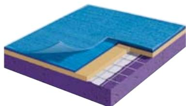
Обработка тройного действия Protectsol® (специальная полиуретановая обработка), многослойная поверхность DMax™ и специальное тиснение делают съемные и постоянные покрытия Taraflex™ futsal лучшими покрытиями для футзала, обеспечивающим быстрые пасы мяча, комфорт и безопасность игрока.
