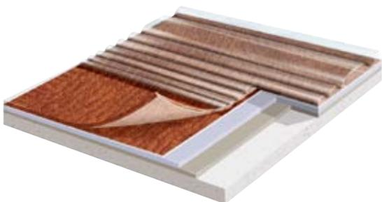
TARASTEP представляет собой гетерогенное напольное покрытие для ступеней толщиной 3.85 мм на вспененной подложке. Состоит из печатного рисунка, прозрачного винилового износостойкого слоя, рельефного носика для безопасности.
